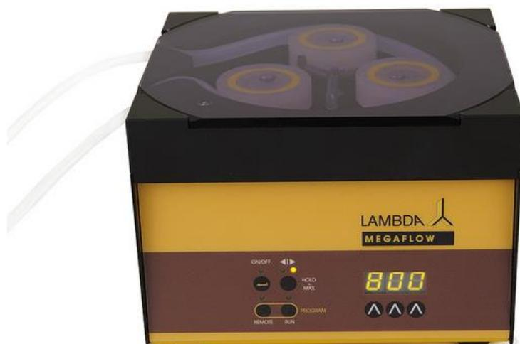
MEGAFLOW es una bomba peristáltica de laboratorio especialmente diseñada para procesos continuos de largo plazo con velocidades de flujo elevadas hasta 60'000 ml/hora. El motor paso a paso BLDC (Brushless DC o de imanes permanentes sincrónicos) movido por una electrónica con cristal de cuarzo y la técnica única de compresión de los tubos en su gran cabezal de bombeo asegura **una máxima precisión del caudal, reproducibilidad y estabilidad a largo plazo.**
